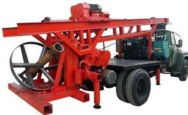
Внедрение продукта двухфазной буровой установки для водяных скважин с удлинением
