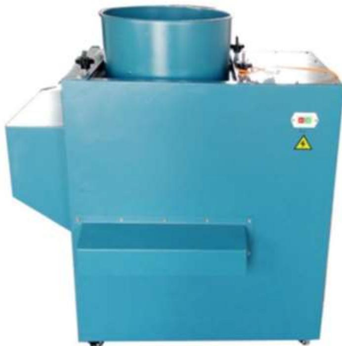
В этой **машине для сепарации чеснока** используется высококачественное колесо из чистого мягкого пластика, которое имитирует действия человека по легкому отделению зубчиков чеснока с коэффициентом разделения 98%. Расстояние между натяжными колесами можно свободно регулировать, чтобы можно было разделить зубчики чеснока любого размера.
